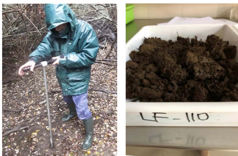
Figura 2. Proceso de toma de muestras en campo (izquierda) y de secado de muestras al aire (derecha).
