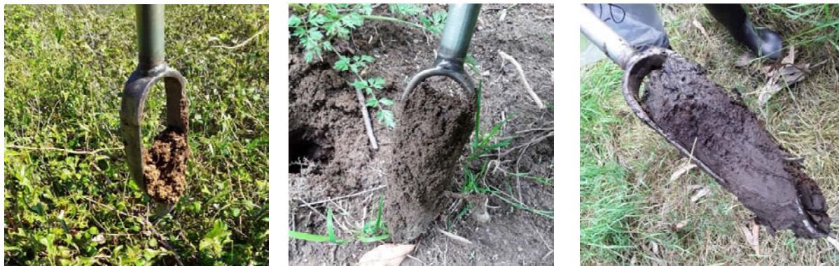
Figura 3. Ejemplos de muestras con diferentes grados de compactación, de izquierda a derecha, muestra con baja compactación, con compactación media y con compactación alta.
