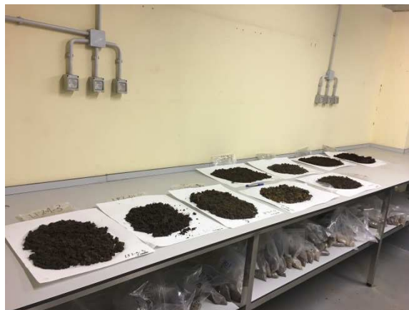
Figura 2. Proceso de toma de muestras en campo (izquierda) y de secado de muestras al aire (derecha).
